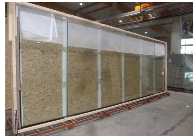
Abb.: Verpackung und Verladung der Glasscheiben mit extra angefertigten Holzkisten
